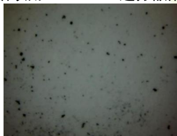
A经过3%R1800-SH处理过的炭黑 0.1g B没有处理过的炭黑0.1g
