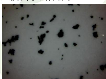
A经过3%R1800-SH处理过的炭黑 0.1g B没有处理过的炭黑0.1g
